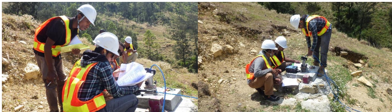
Figura: fotografia husi Monitorizasaun ekipamentu Inklinometru iha Talude Estrada A05, Aituto
